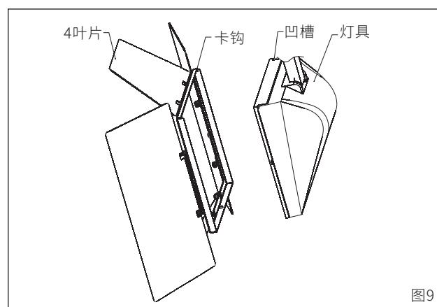
2.锁紧底部的紧固螺丝及完成4叶片的固定，然后调节叶片的角度来达到想要的出光效果（图9）。
