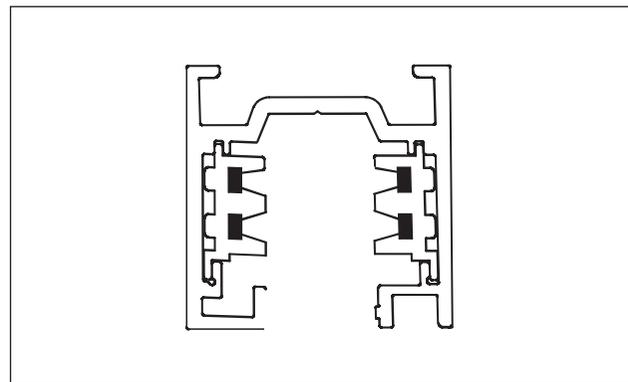
B.安装前须将接电触片旋钮调到图示位置；
